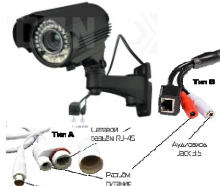
Распринка RCA разъёмы для типа А
