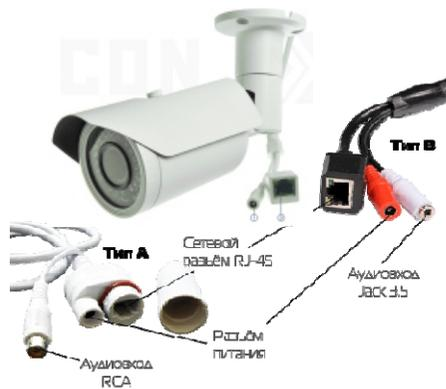
Разъемы RCA разъёмы для типа А
