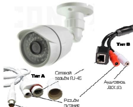
Распиновка RCA разъёма для типа А
