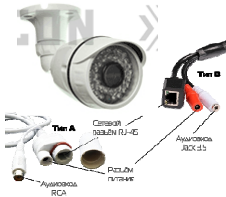
Разъемы RCA разъемы для типа А
